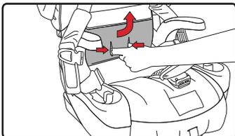
**2** Desacople los enganches de retención que se encuentran en la parte posterior de la cubierta del asiento. Jale de la cubierta del asiento y de la pieza de espuma hacia delante.
