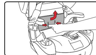
3 Desacople los enganches de retención que se encuentran en la parte posterior de la cubierta del asiento. Jale de la cubierta del asiento hacia delante y por encima de la almohadilla abdominal.
