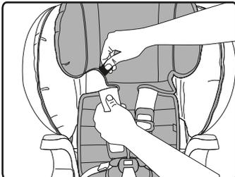
**4 Desenganche las cintas elásticas superiores situadas en ambos laterales del reposacabezas.**
