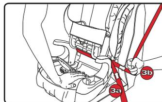
**IMPORTANTE:** Sólo eliminar la holgura del cinturón de seguridad del vehículo. Si se aprieta demasiado el cinturón puede impedir que el CLICKTIGHT asegure adecuadamente.
