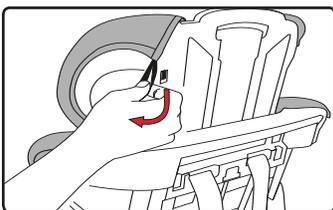
**5 Desenganche las cintas elásticas inferiores situadas en ambos laterales del reposacabezas y, a continuación, retire la cubierta del reposacabezas.**
