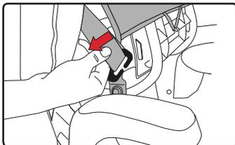
**6** Pase las correas del arnés por las ranuras de la cubierta y del exterior del asiento, y por encima del placa de ajuste del arnés, hacia la parte posterior del asiento de seguridad para niños.
