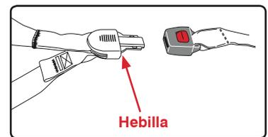
**NOTA:** Para utilizar un asiento de seguridad para niños con este tipo de cinturón de seguridad, debe cambiar el sistema retráctil por el cinturón de banda horizontal al modo de sistema bloqueo automático.
