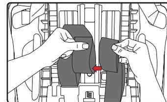
**8** Extraiga el gancho del arnés del compartimento situado debajo del exterior del asiento y pase las correas del arnés, completamente, por el gancho del arnés.
