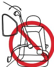
Cinturones sobre el hombro y la cadera con puntos de anclaje superiores o inferiores en la puerta del vehículo.
