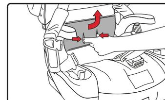
5 Desacople los enganches de retención que se encuentran en la parte posterior de la cubierta del asiento. Jale de la cubierta del asiento y de la pieza de espuma hacia delante, y por encima de la almohadilla abdominal EZ-Buckle.
