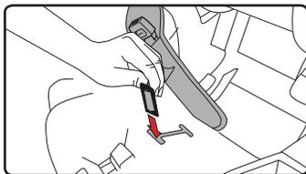
**4** Pase la almohadilla abdominal EZ-Buckle por la ranura correspondiente en la cubierta del asiento. Vuelva a colocar la cubierta del asiento en su posición original y acople los enganches de retención.
