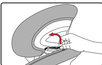
**6 Desenganche las cintas elásticas y retire las cubiertas laterales de ambos laterales del exterior del asiento de seguridad para niños.**
