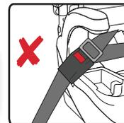
Si la hebilla se encuentra cerca de la posición incorrecta (X) cuando el cinturón de seguridad está tensado, intente ajustar el asiento de seguridad para niños en otro asiento del vehículo. Si no consigue colocar la hebilla en la posición correcta (✓) DEBERÁ usar otro asiento del vehículo.
