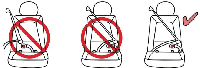
El cinturón de seguridad del vehículo está debidamente colocado cuando la banda a horizontal queda a la altura de la cadera del niño (b) y la banda transversal cruza el hombro y no está en contacto con el cuello del niño cuando se coloca en la guía del cinturón superior (a).
