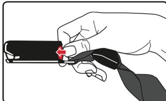
2 Jale del conector inferior para extraerlo del compartimento o anclaje inferior.
