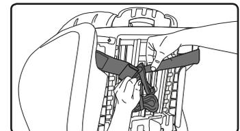
2 Presione con fuerza el gancho situado encima del punto del anclaje de retención.
