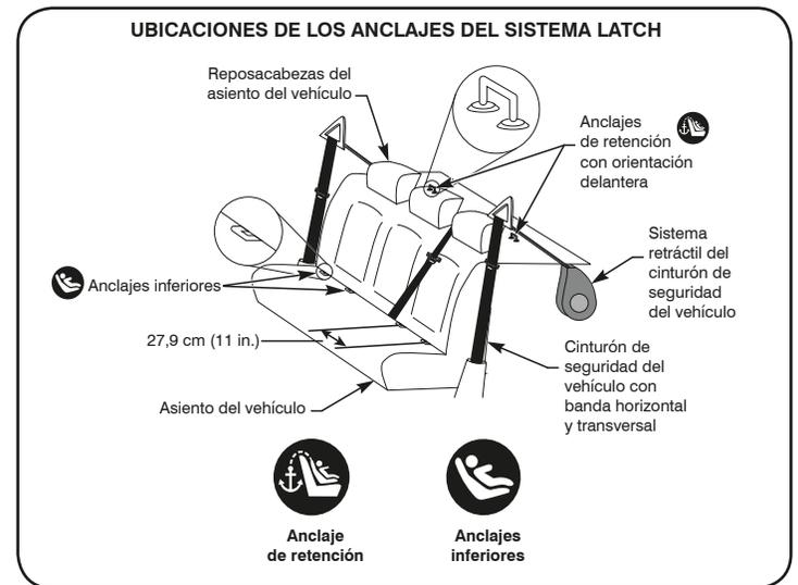
Los anclajes inferiores y las correas de fijación para niños o LATCH es un sistema disponible en este asiento para niños que ofrece una alternativa a los métodos de instalación del cinturón de seguridad del vehículo. La figura arriba muestra las posiciones habituales de los anclajes inferiores de las correas en un vehículo. Consulte las páginas 50-51 para conocer los componentes LATCH de este asiento para niños.
