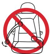
Cinturones sobre la cadera con placa de enganche cosida y un separador que se bloquea únicamente en caso de una detención repentina.
