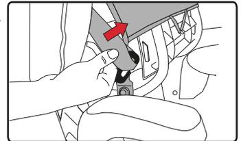
**6 Suelte los enganches que se encuentran en la parte posterior de la cubierta del asiento de seguridad para niños; a continuación, jale de la cubierta del asiento hacia delante y por encima de la almohadilla abdominal EZ-Buckle.**
