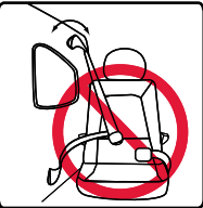
Cinturones con banda horizontal y transversal, con puntos de anclaje superiores o inferiores en la puerta del vehículo.
