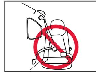
1 Cinturones de seguridad para vehículos, con puntos de anclaje superiores o inferiores en la puerta del vehículo.
